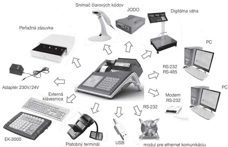
Obrázok 2.2 Externé zariadenia pripojiteľné k pokladniciam Euro-2100TE
